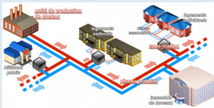
Constitution d'un réseau de chaleur (source : http://www.developpement-durable.gouv.fr/ )
